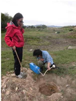
写真 3 尾鉱堆積場における水銀 発散量の測定
