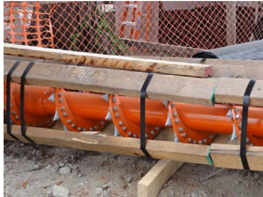
写真5 木質チップ送管用ブレード
