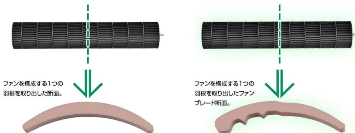
図 22 従来のファンの断面（左）と、トンボの羽根の形状を応用したファンの断面（右）
