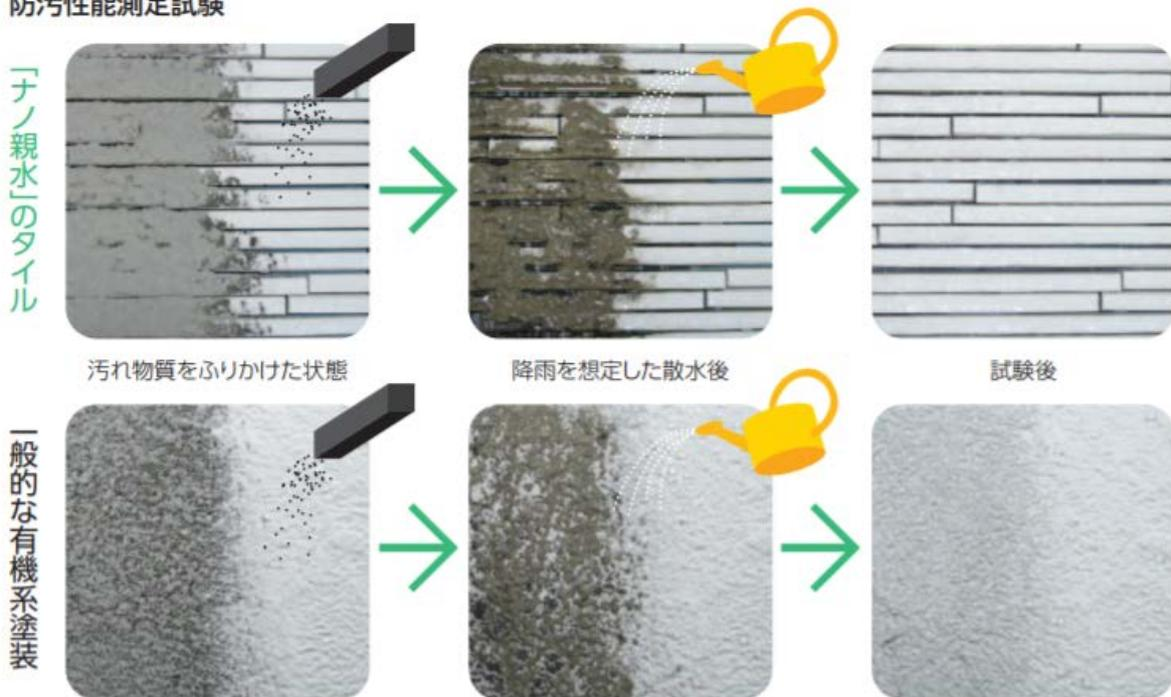
図 18 ナノ親水タイル及び一般的な有機系塗装の防汚性能測定試験
