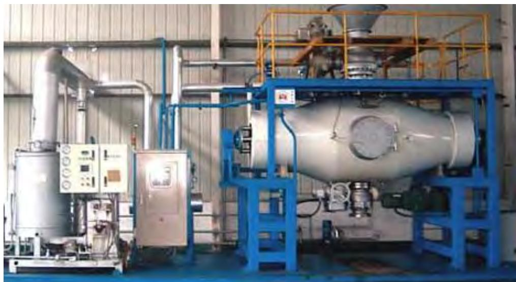
図 57 亜臨界水反応装置 出所) 株式会社エース・クリーン
