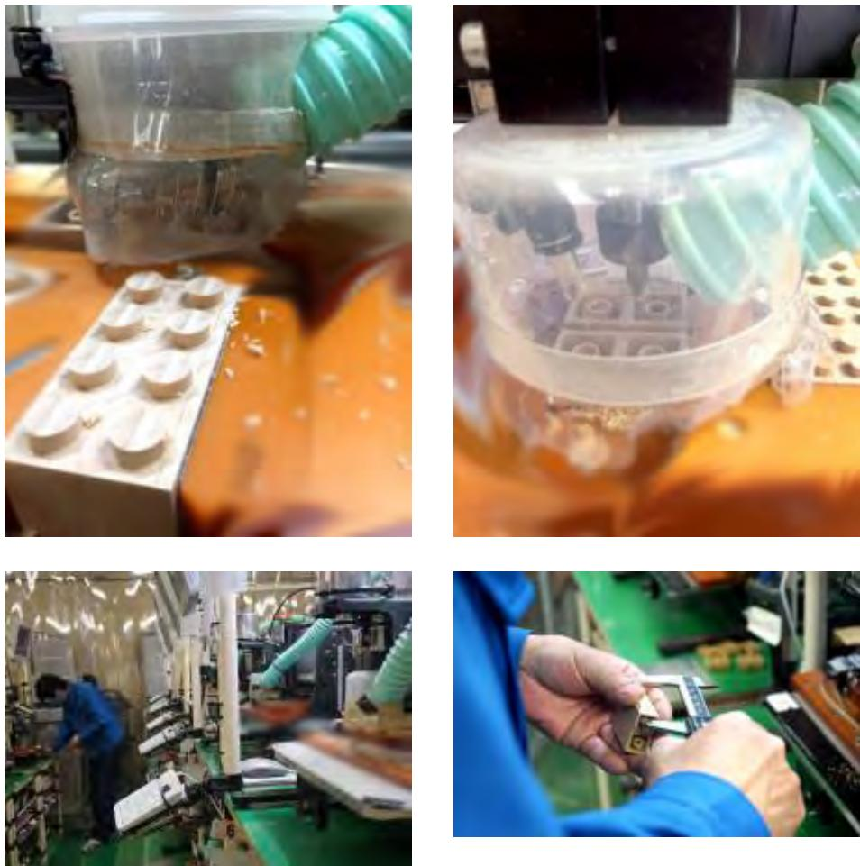
図 60 「もくロック」の切削加工工程。1/100mm 単位で加工している
