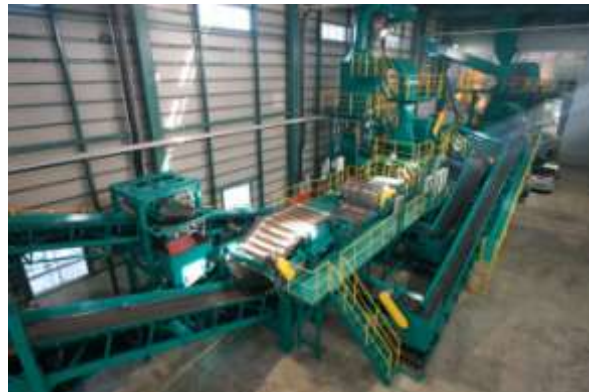
図表 235 2000馬力シュレッダー、鉄回収を行う中央磁性物選別ライン
