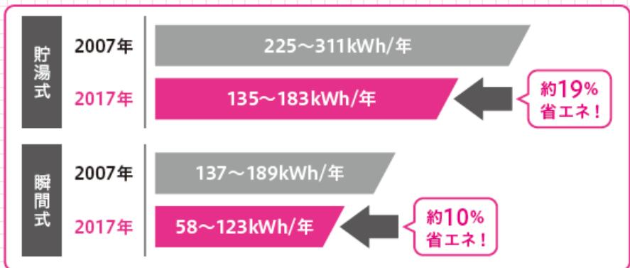
図 2007年(平成19年)の温水洗浄便座(貯湯式／瞬間式)と最新の温水洗浄便座の比較
