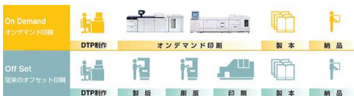
図1 デジタル印刷（オンデマンド印刷）とオフセット印刷の工程の流れ
