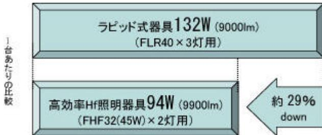
高周波点灯方式の点灯装置とHf蛍光ランプの採用により、エネルギー消費効率の向上や灯数の削減が可能になります。
