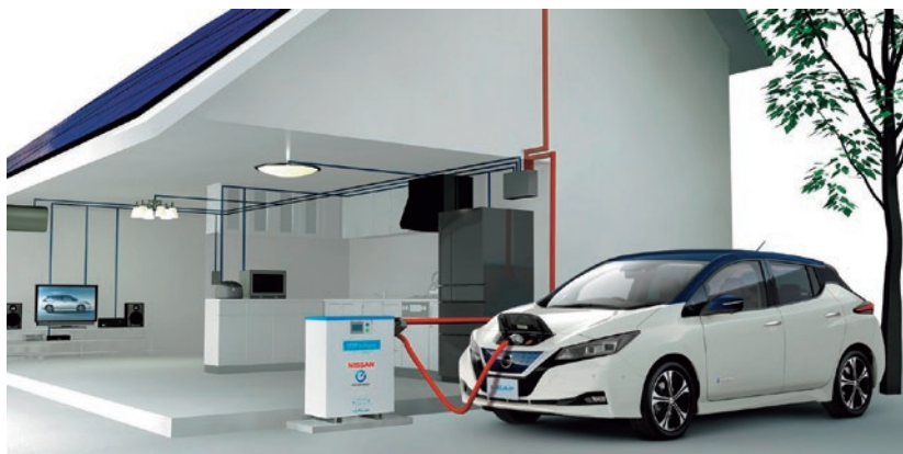
図3-2-8 電気自動車の家庭における電源活用のイメージ[V2H (Vehicle to Home)]
