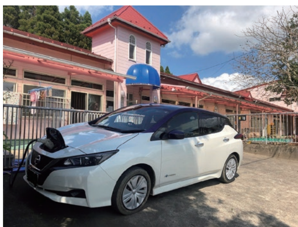
写真2-1-3 停電時における保育園への給電 (令和元年房総半島台風)
