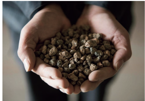
排水処理で発生する余剰汚泥から作られる発泡セラミックス
