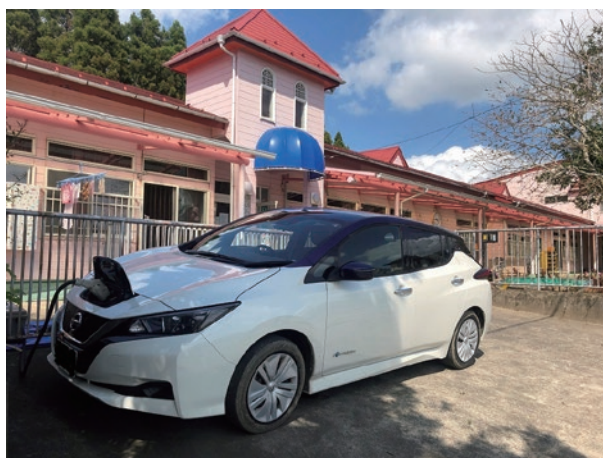
写真2-1-3 停電時における保育園への給電 (令和元年房総半島台風)
