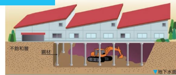
建物を解体せずに、建物の下の汚染土壤を浄化する技術
