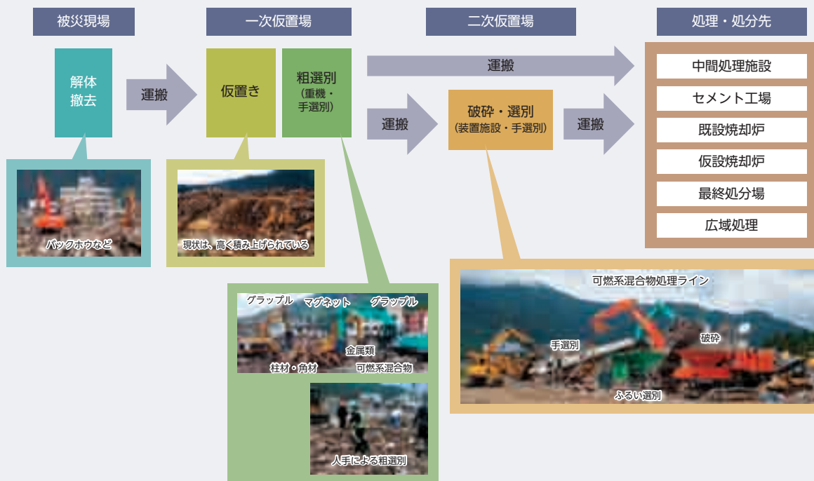
図2-1-3 岩手県における災害廃棄物の処理手順
