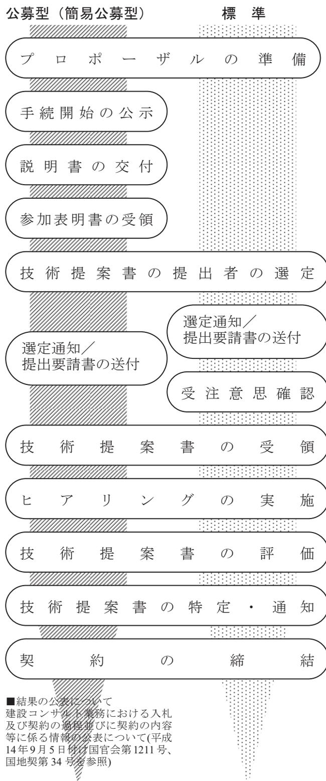
図VI-5-1 プロポーザル方式の手続の流れ
