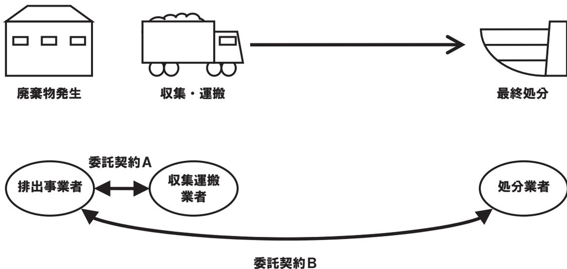
図Ⅶ-2-3 収集運搬と最終処分を委託する場合の処理フローと処理委託
