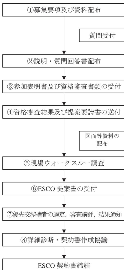
図V-3-2 プロポーザル方式による、ESCO事業の導入フロー例（事業者選定・契約段階）
