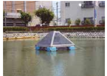
環境配慮型攪拌装置
