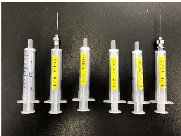
試料ガス注入用シリンジ (SGHA-P3-A)
