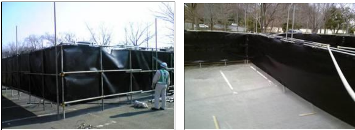
図 3-3 隔離水界の構造（左：隔離水界の外側、右：隔離水界の内側）
