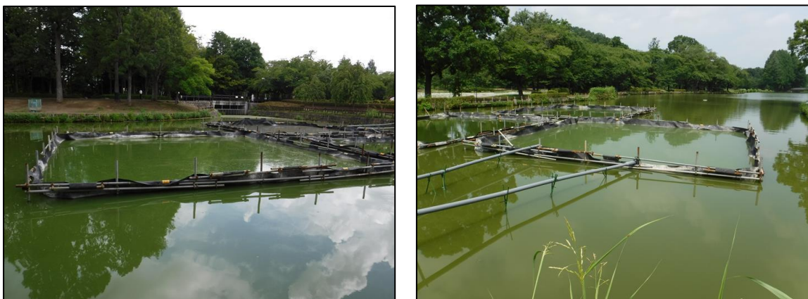
図 3-4 隔離水界の配置（左：対照区、右：試験区）
