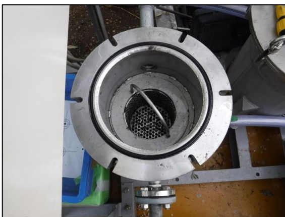
図 5-6 SS 除去ストレーナ兼磁性体凝集剤注入器
