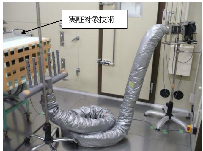
写真 4-3 実証対象技術のヒートポンプ、二次側吸込み空気温度の測定装置
