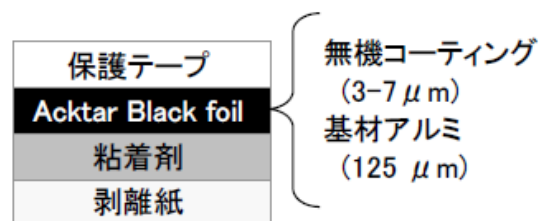
図 4-7 Spectral Black の構造 (Acktar Ltd.の HP を参考に作成)
