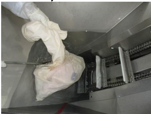
水中浸漬装置 (綿袋中の紙おむつの浸漬の様子)
