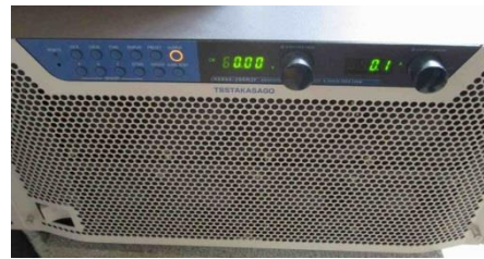
直流電源装置
