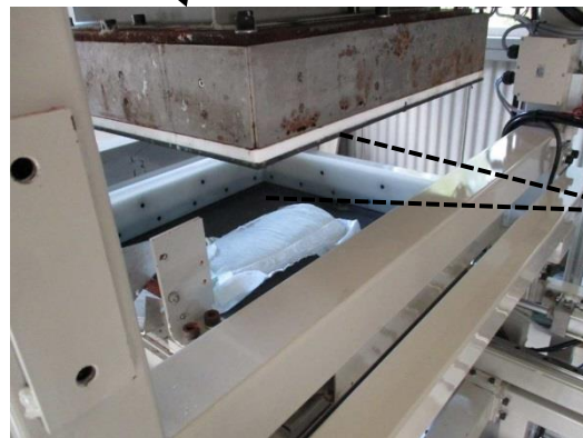
電気浸透脱水装置（解放時） (紙おむつを裁断せずに処理したケース)
