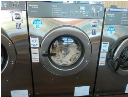
模擬洗濯物（タオル）の洗濯
