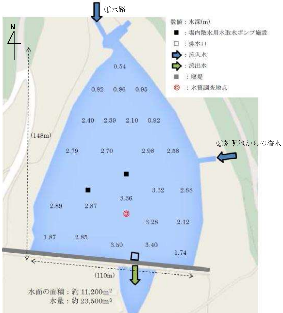
図 3-9 実証試験実施場所（試験 2）における実証対象技術の設置地点と試験池の水深
