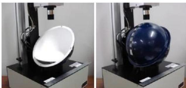
図 4-4 反射積分球外観
