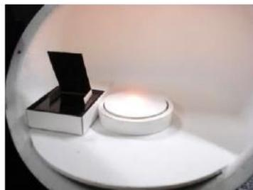
c) 上方反射の基準光量測定
