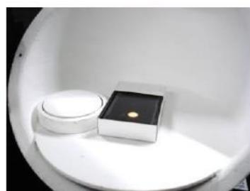
b) 半球反射の光量測定
