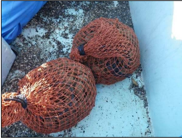
図1 試験に用いたスラグ造粒物(7kg)
