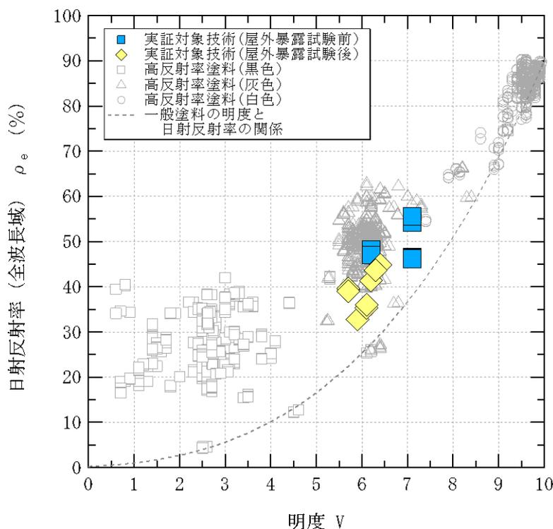
※左図は、平成20年度～平成25年度環境技術実証事業ヒートアイランド対策技術分野(建築物外皮による空調負荷低減等技術)において実証を行った高反射率塗料(高反射率防水仕上塗料を含む)と一般塗料の明度と日射反射率(全波長域)の関係を示したものである。
