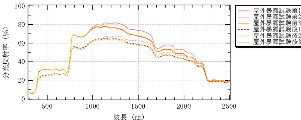
図-3 分光反射率測定結果 (N6)
