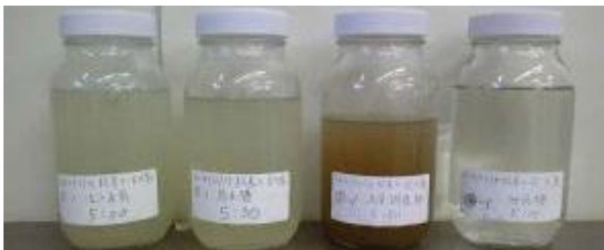
12月19日5時の処理工程の採水試料（左から 流入水、原水槽、流量調整槽、処理水）
