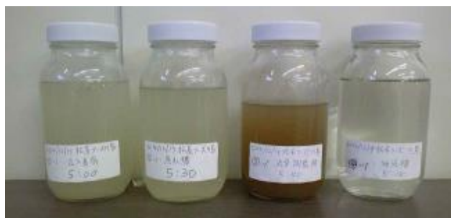
流入 原水槽 流量調整槽 処理水
