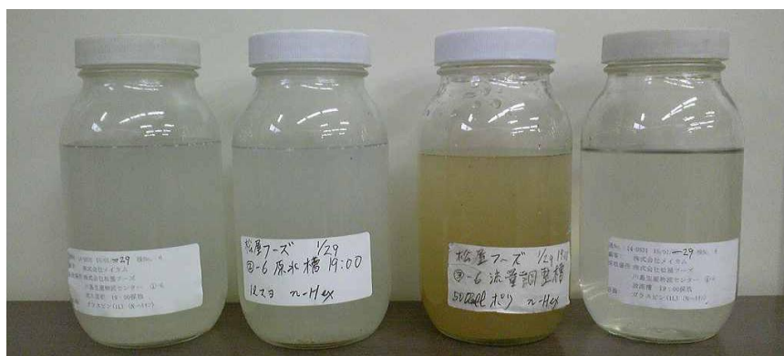
1月29日19時の流入水の採水試料（左から 流入水、原水槽、流量調整槽、処理水）
