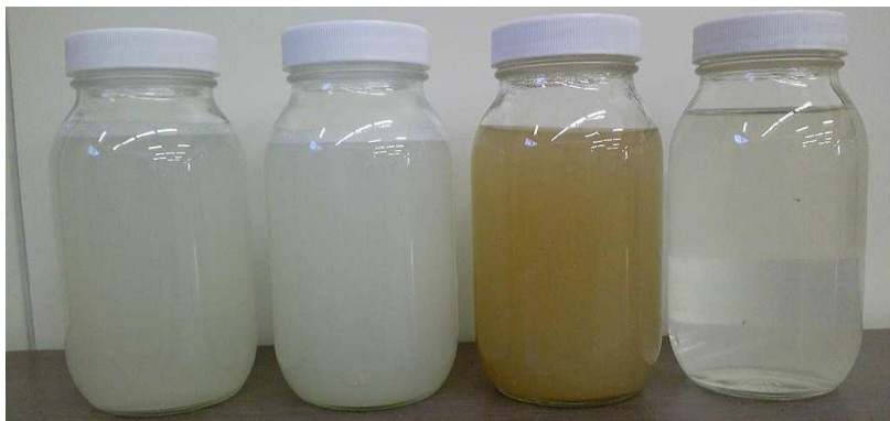
2月19日19時の流入水の採水試料（左から 流入水、原水槽、流量調整槽、処理水）
