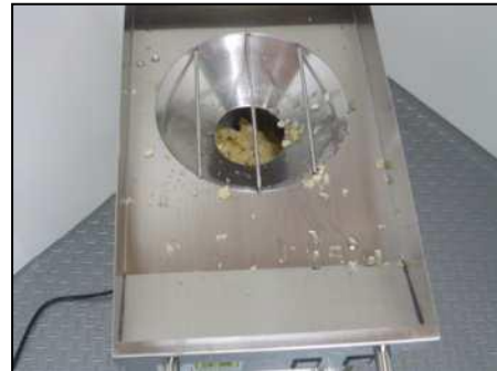
④上部トレイを閉めてスタートボタンを押し、搾油を行う。(1500rpmで30秒)
