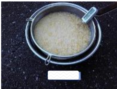
②【水冷試験】漬け置き 揚げかす類：533g
