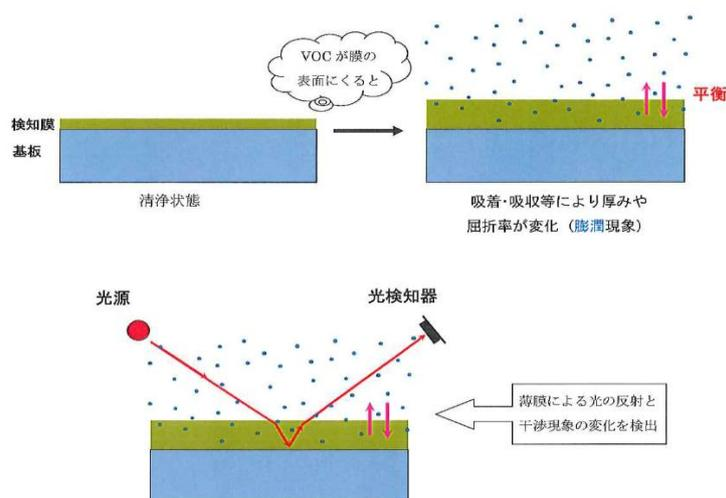
図 A VOC 成分による高分子膜の膨潤イメージ
