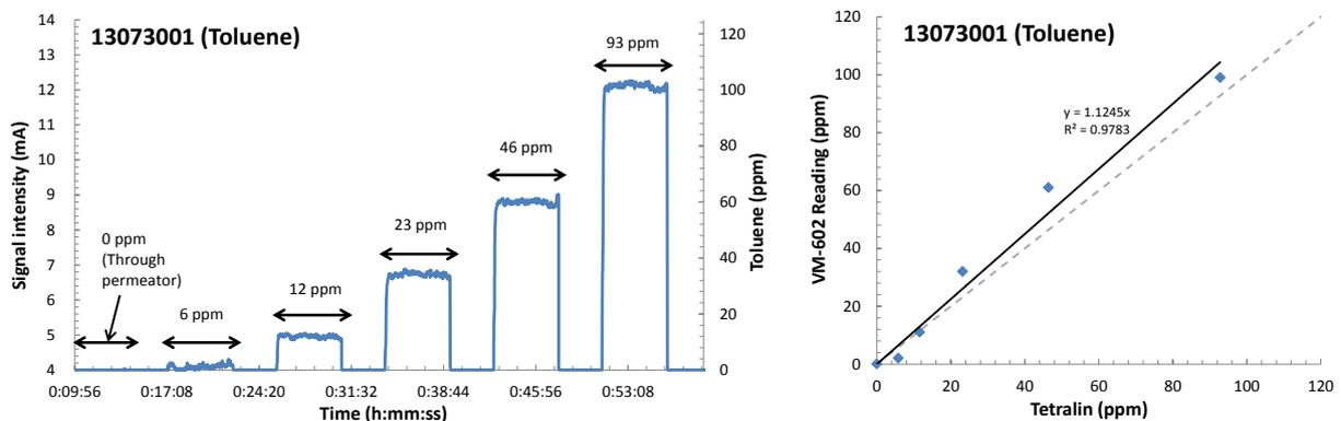
図 1. VM-603 にてトルエンを計測した結果、(左) 濃度を変化させて計測した時間変化。(右) 作成したトルエン濃度と VM-603 の指示値、横軸は作成したトルエン濃度、縦軸は VM-603 表示濃度。破線は 1:1 に対応する線。
