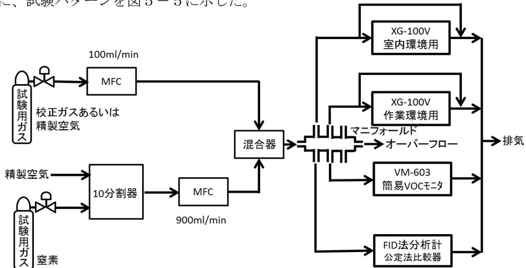
図5-4 酸素影響試験の流路系統図
