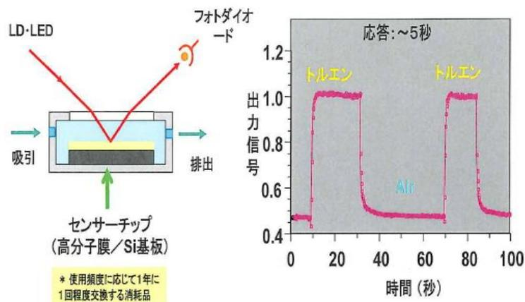
図 C VOC センサ構成図と応答信号
