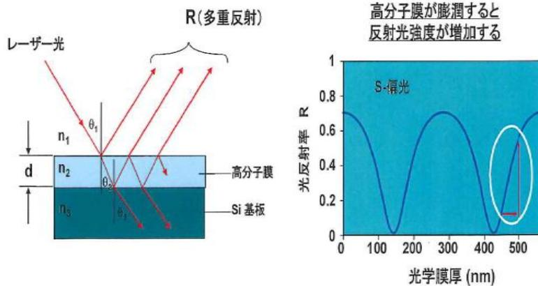
図 B IER 法の原理図 (薄膜干渉と IER 曲線)
