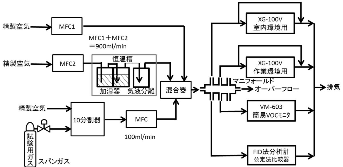
図 5-8 水分影響試験の流路系統図
