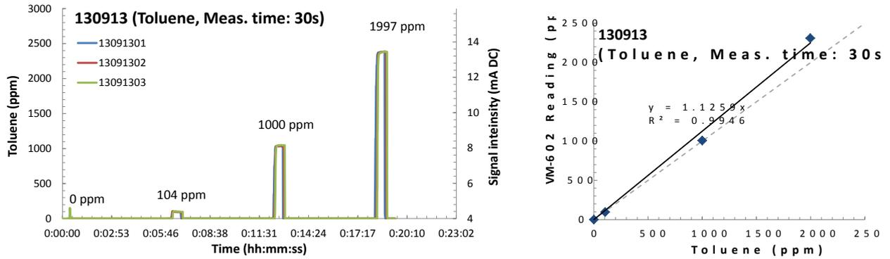
図 2. (右) トルエン計測の時間変化。3 回の計測結果。(左) 試料のトルエン濃度と VM-603 の表示値の関係。左図 3 回の計測の平均と標準偏差。黒直線は回帰直線、灰破線は 1:1 に対応する線。
