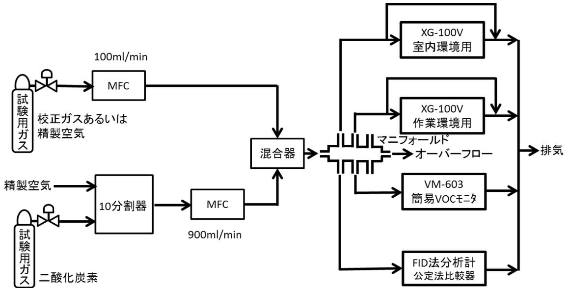
図 5-6 二酸化炭素影響試験の流路系統図
