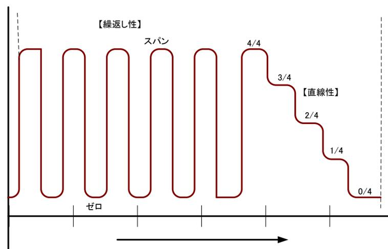
図5-3 繰返し性、直線性試験パターン
