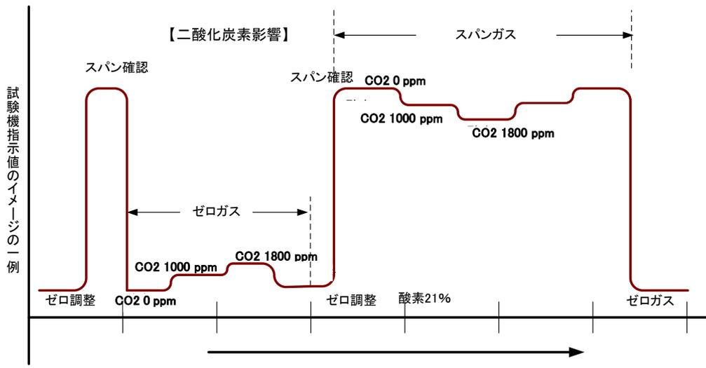
図 5-7 二酸化炭素影響試験のパターン
