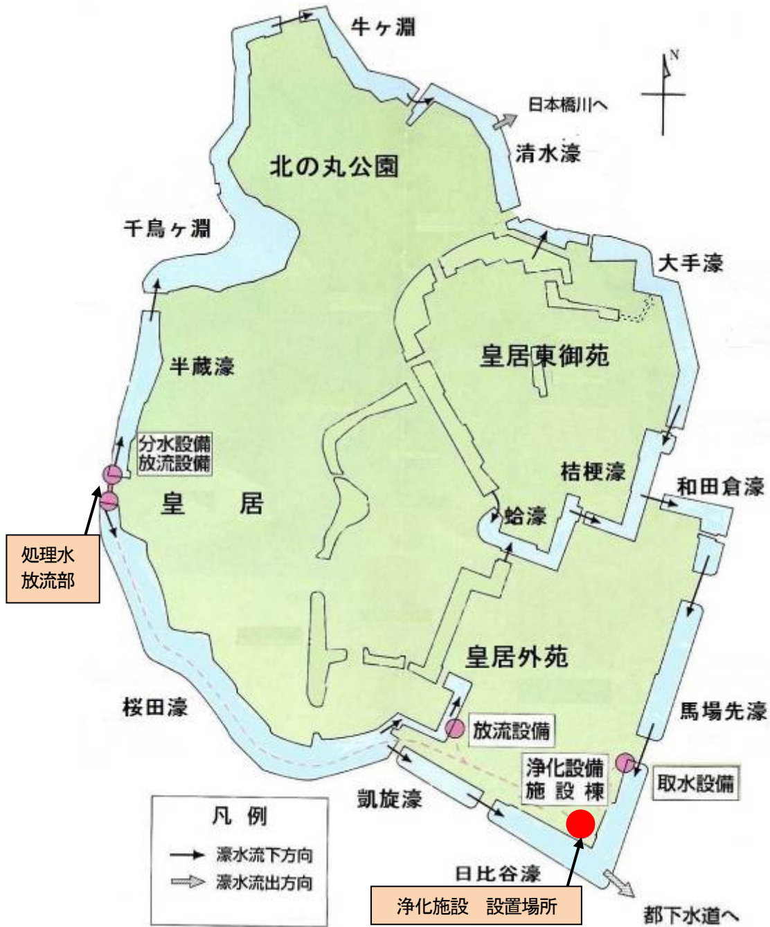
図 3-1 皇居外苑濠水浄化施設・配水系統図(環境省皇居外苑管理事務所 濠水浄化施設ホームページより)
