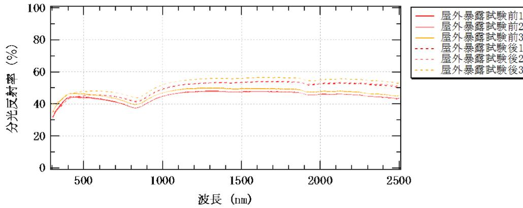
図-2 分光反射率測定結果 (シルバー)
