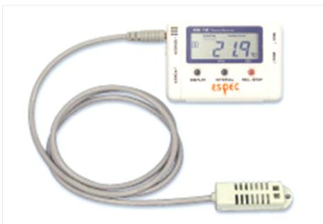
写真 5-4-1-2 温湿度センサーの外観
