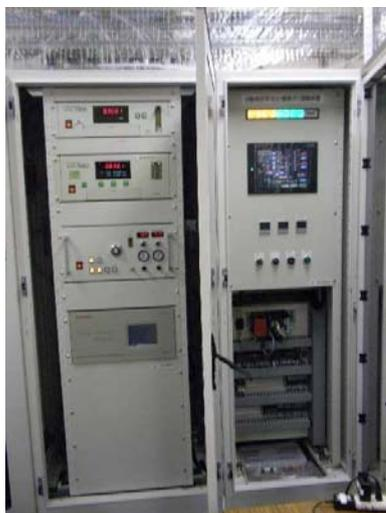
試験用ガス調製装置 (一部のみ使用)
