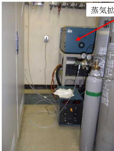
試験用ガス調製装置
