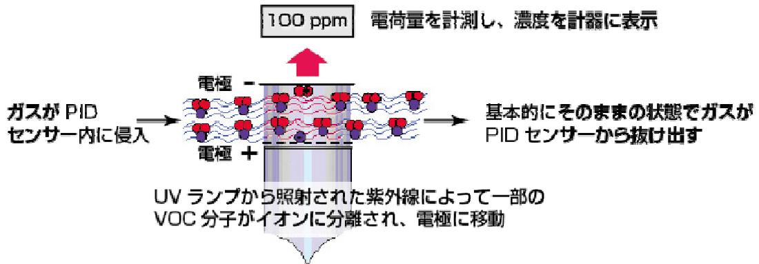
PID は、イオン化エネルギー (IE) がランプの光子エネルギーより低いすべての化合物の測定を行う。提供されるランプは、9.8、10.6 および 11.7eV の 3 種のランプである (PGM-1800 は 10.6eV)。
