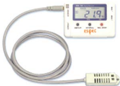
写真 5-4-1-3 温湿度センサーの外観
