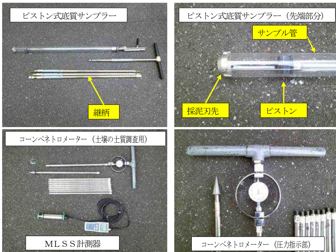
図4-3 底質の厚さの測定の計測器、底質の採取の器具
