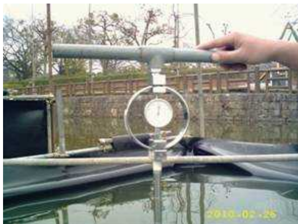
図4-4 コーンペネトロメーターによる底質の下面の測定
