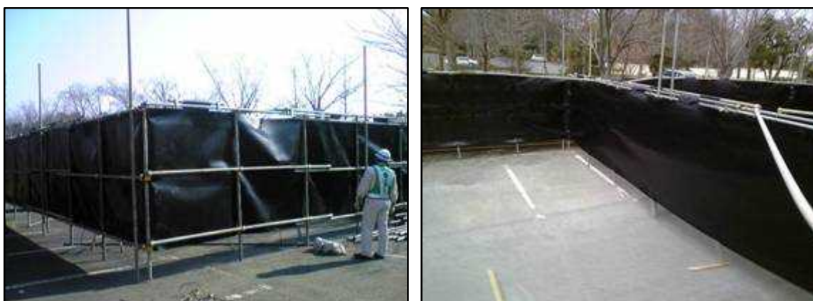
図3-3 隔離水界の構造（右：隔離水界の外側、左：隔離水界の内側）
