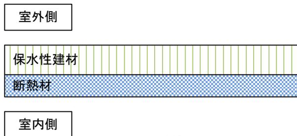
図 2-1 屋上（屋根）面の材料構成
