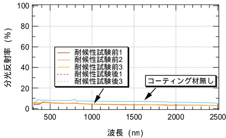
図 - 2 分光反射率測定結果
