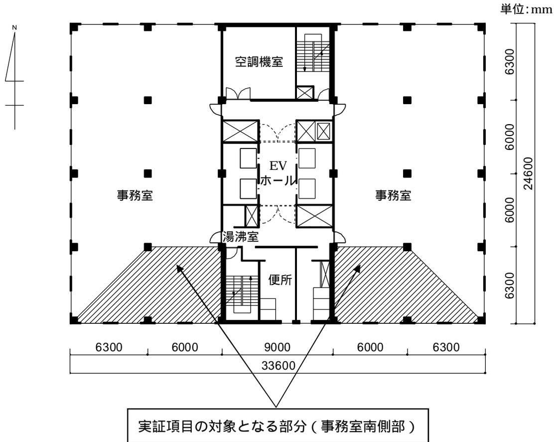
図 4-2 計算用オフィスモデル (平面図)
