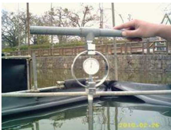
写真4-3 コーンペネトロメーターによる底質の下面の測定
