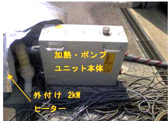
加熱・ポンプユニットの写真
