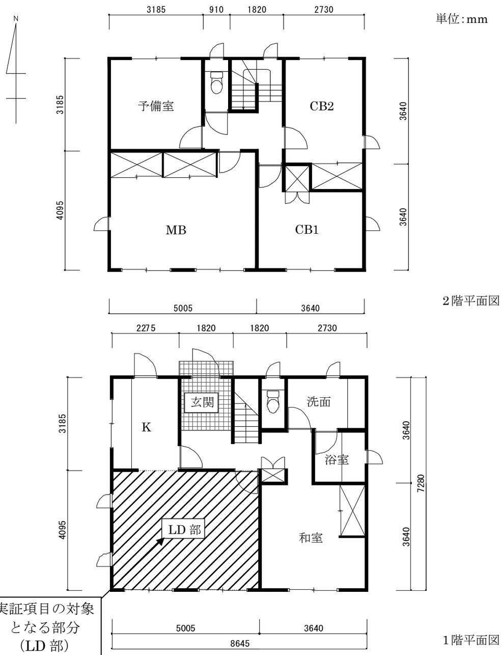
図 4-1 計算用住宅モデル (平面図)
