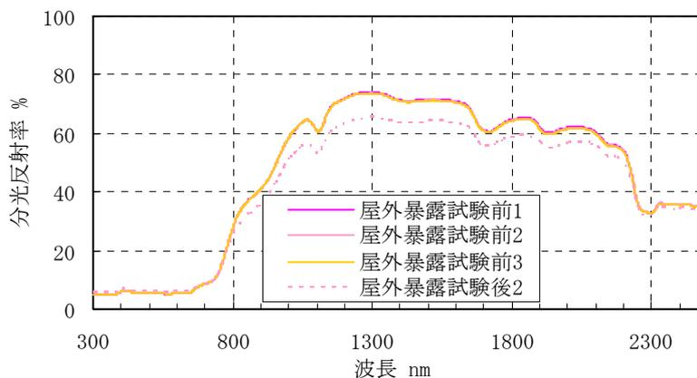
図-2 分光反射率測定結果 (黒色)
