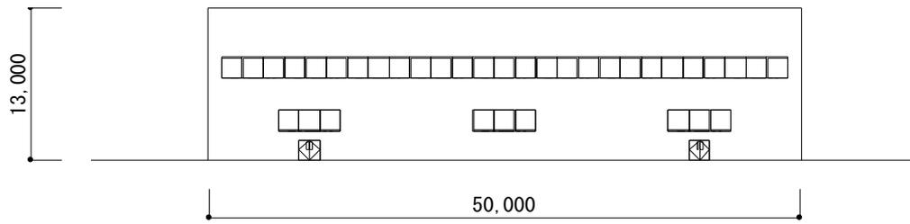
付図 1 計算用工場モデル (南側立面図)
