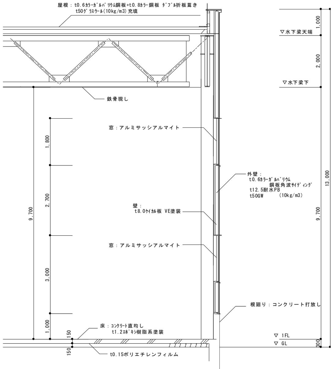
付図 4 計算用工場モデル (矩計図)
