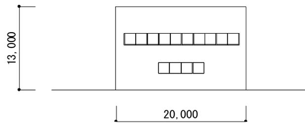
付図 2 計算用工場モデル (東側立面図)
