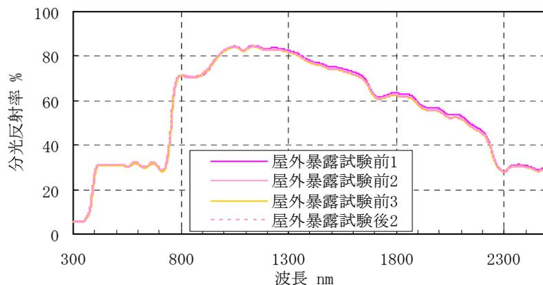
図-3 分光反射率測定結果 (灰色)
