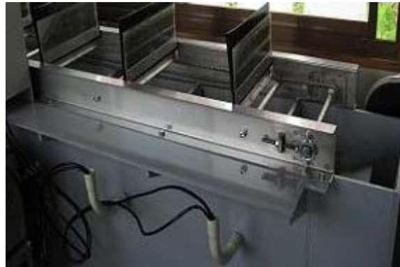
図 3-3 電気分解処理装置
