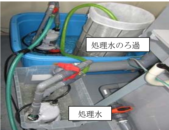
図10 処理水ろ過装置
