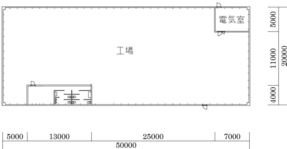
図 3 - 1 モデル的な工場（断熱仕様）の平面図
