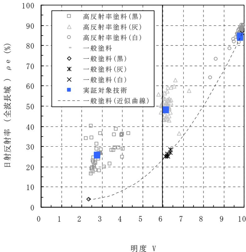
※左図は、平成 20 年度環境技術実証事業ヒートアイランド対策技術（建築物外皮による空調負荷低減等技術）において実証を行った高反射率塗料と一般塗料の明度と日射反射率（全波長域）の関係を示したものである。
