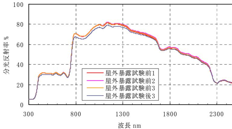
図 5 - 2 分光反射率測定結果（灰色）
