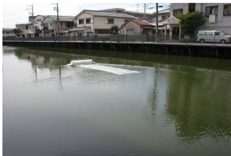
図2 アオコ制御施工装置
