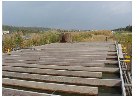
図3 実証対象装置である藻床水路 (正面奥の流量調節槽から水塊の水を供給)
