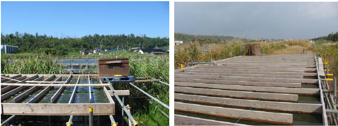
図3-4 実験池水塊横に設置された実証対象装置である藻床水路
