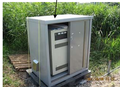
図5 水塊外に置かれたオゾン発生装置
