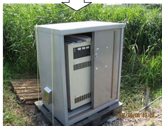
図3-5 水塊外に置かれたオゾン発生装置
