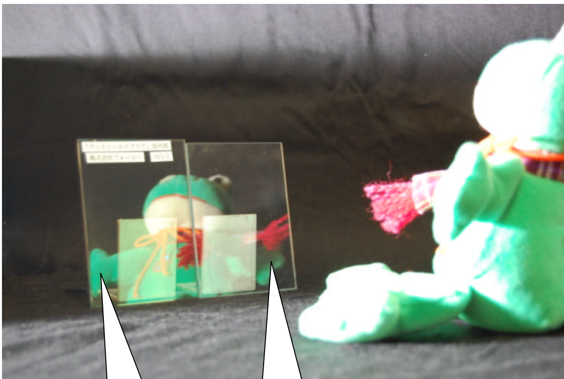
コーティング材施工後の ガラス反射像
